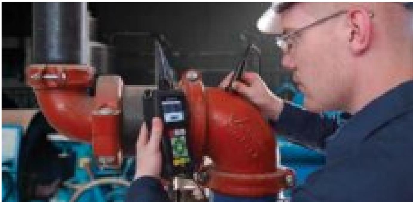
45MG仪器是一款带有各种标准测量功能和软件选项的高级超声测厚仪。这款独具特色的仪器与所有Olympus双晶和单晶测厚探头兼容，是一款集所有解决方案于一机的创新型仪器，可用于几乎所有测厚应用。
